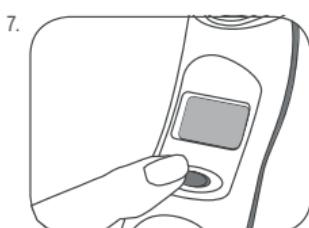
7. Para encender, mantén presionado el botón 'On/Mem' (Encendido/Memoria) durante aproximadamente 5 segundos, hasta que la pantalla LCD muestre 'o-'. El termómetro se apagará automáticamente después de 1 minuto si no está encendido, lo que prolonga la duración de la batería.
