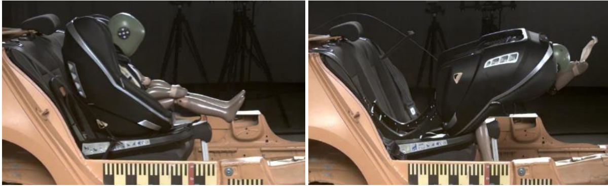
Figura 2: Foppapedretti Uniko i-Size en el ensayo de impacto frontal con el maniquí Q3
