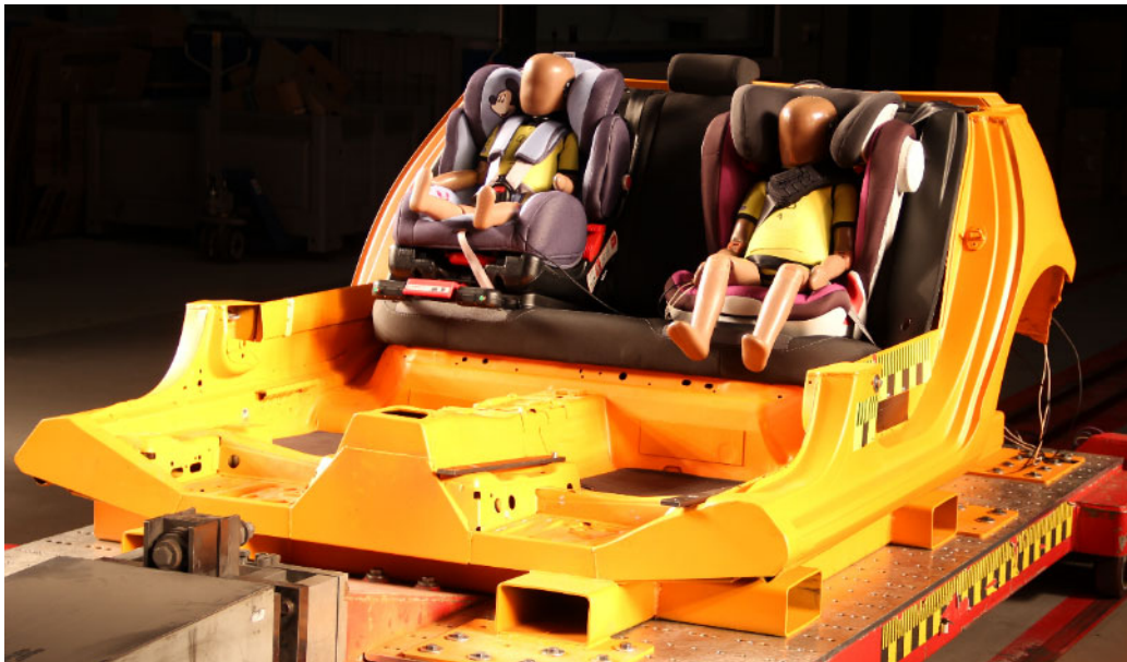
Figura 5: Diseño del ensayo de impacto frontal
