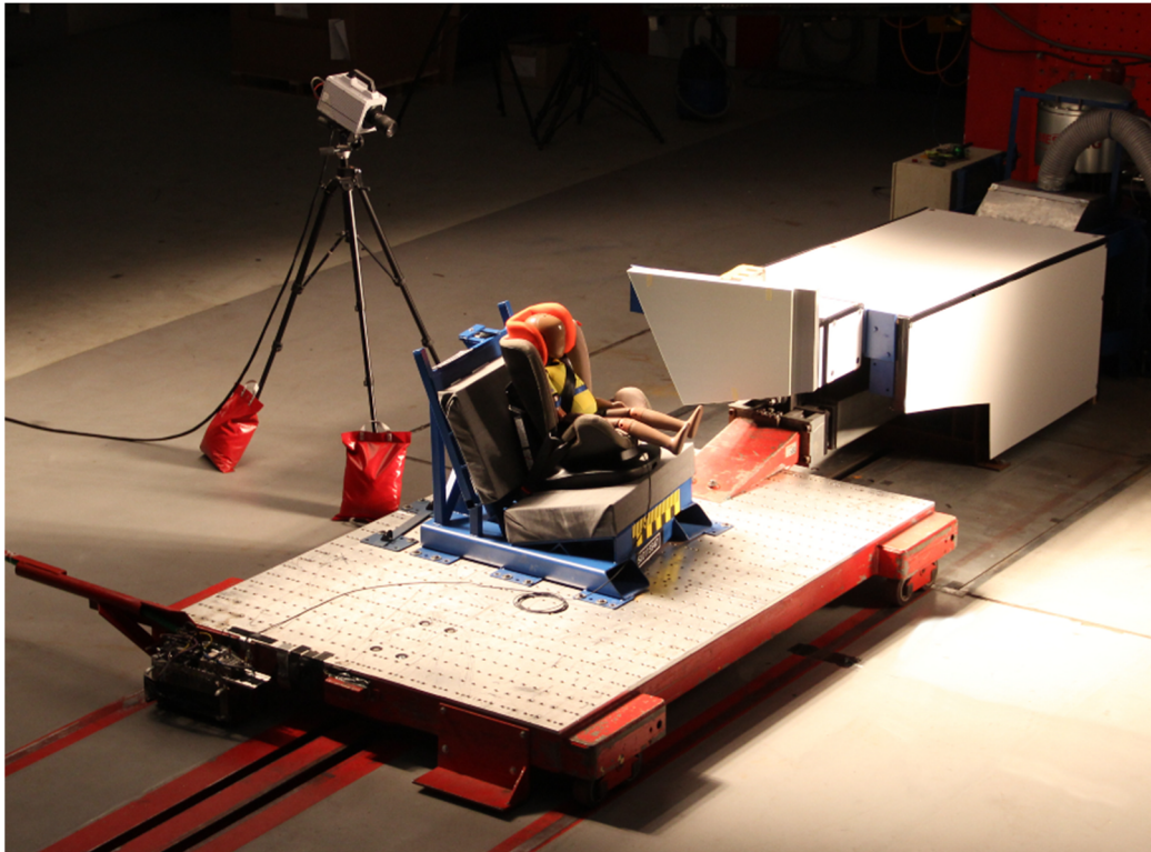
Figura 6: Diseño del ensayo de impacto lateral
