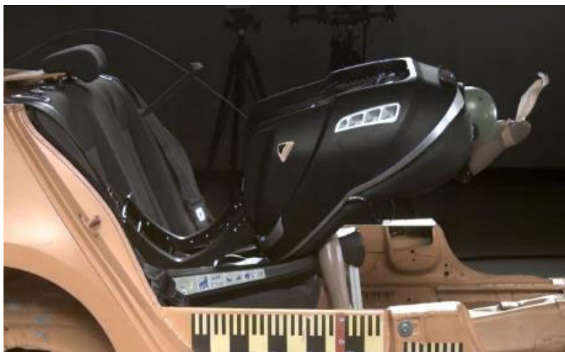
Figura 1: Foppapedretti Uniko i-Size en el ensayo de impacto frontal con el maniquí Q3
