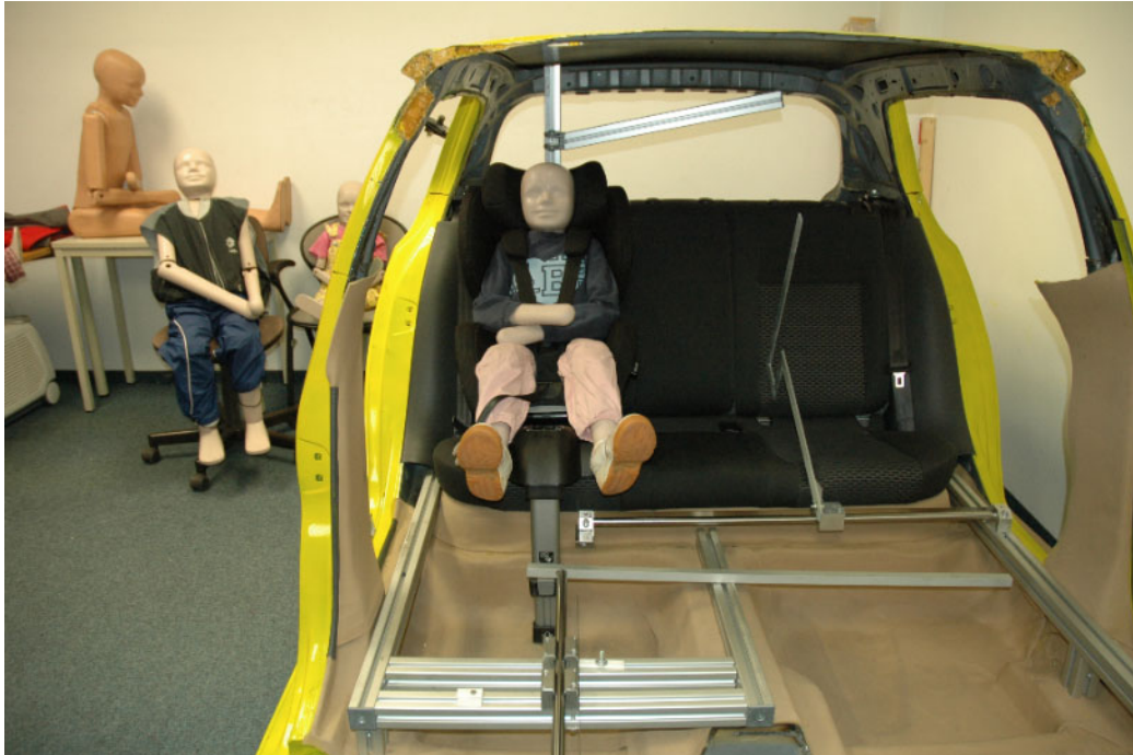
Figura 8: Diseño del ensayo para evaluar la ergonomía
